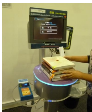
特許を取得した自動貸出機。 5冊同時にスキャン可能
